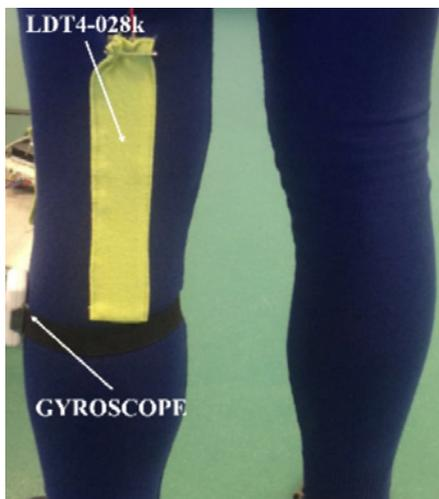
Fig. 3 – Particolare del posizionamento del sensore PVDF
