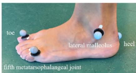
Fig. 2 – Posizionamento dei sensori inerziali. Per confronto, sono visibili anche i marker utilizzati
