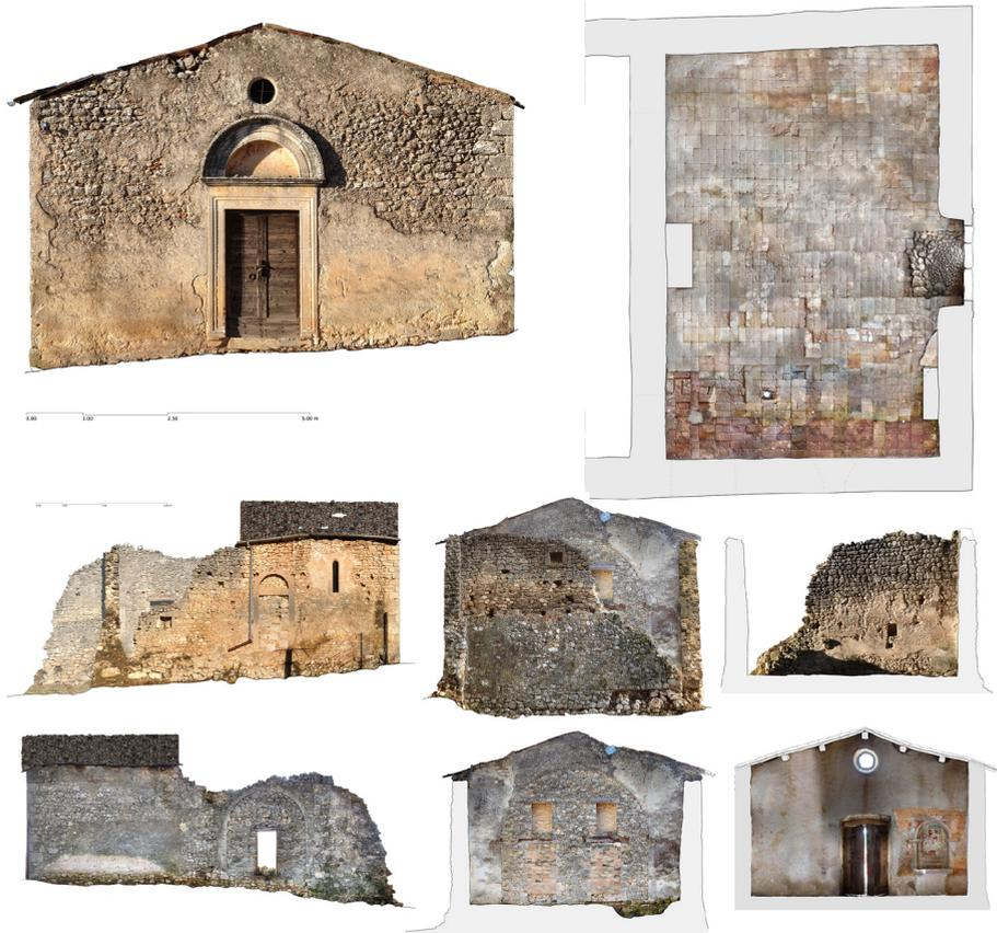
3 Restituzione fotogrammetrica della chiesa di San Sebastiano: facciata, pavimentazione dell'ambiente coperto, prospetti laterali e sezioni trasversali.
