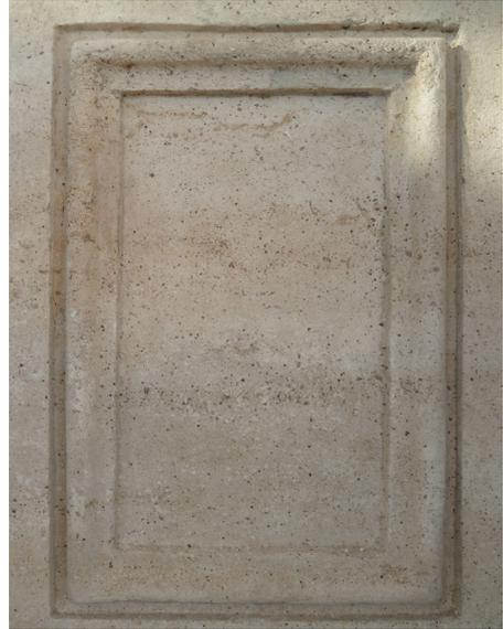
20 Prova riuscita di falso travertino da applicare alle membrature architettoniche.
