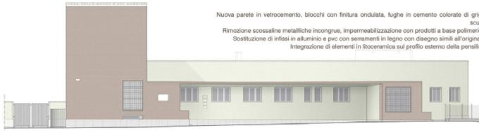
Nuova parete in vetrocemento, blocchi con finitura ondulata, fughe in cemento colorate di grigio scuro.
