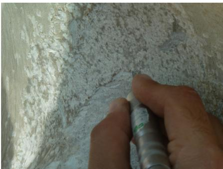
14 Microscalpello elettrico utilizzato nella rimozione dei depositi calcari.
