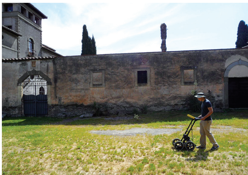
Fig. 1 – Esempio di sistema georadar (FINDAR – Sensors & Software, Inc.) durante le misure a Villa Maruffi
