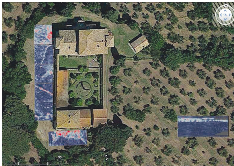
Fig. 3 – In questa figura sono evidenziate le mappe georadar alla profondità di circa 1m. In rosso si notano le anomalie più significative intorno alla villa. In particolare, alcune anomalie allungate in prossimità dell'ingresso principale insieme con una forte anomalia quadrangolare sul lato sud della villa sono relative probabilmente a strutture murarie. Inoltre, nel campo coltivato ad est della villa, si nota l'anomalia georadar connessa al criptoportico parzialmente conservato
