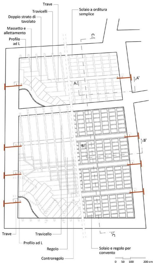
IRRIGIDIMENTO PLANARE DEL SOLAIO E MIGLIORAMENTO SISMICO DELLA SCATOLA MURARIA
