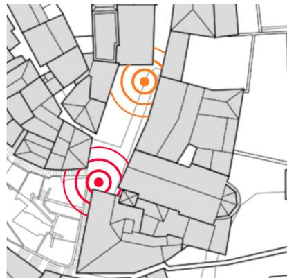
**Fig. 7** Definizione della classe di soleggiamento: analisi e metodo di calcolo in base al numero di ore e alle fasce orarie in cui i due punti analizzati, a Piazza G. Garibaldi, ricevono l'irraggiamento solare il 21 giugno 2021 (a N: 3h20', dalle 11:30 alle 14:50, a S: 5h50', dalle 10:45 alle 16:35; il numero di ore è diverso, la fascia oraria è la stessa, con il peso maggiore).
