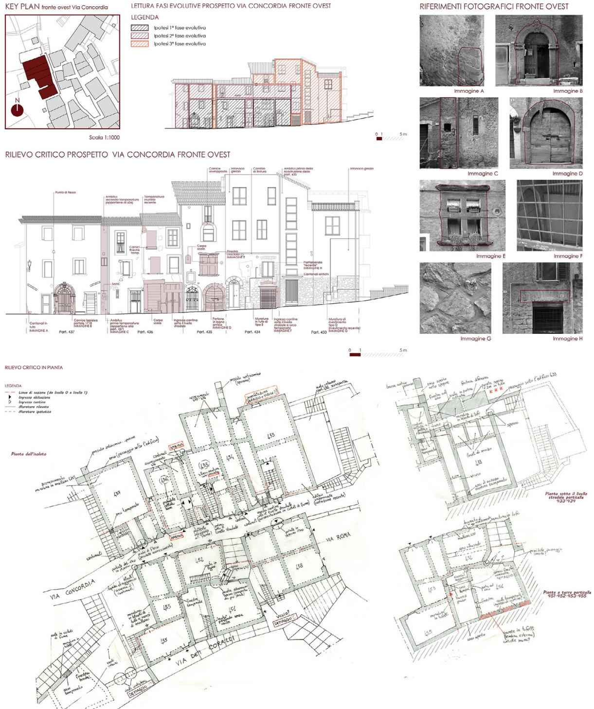
La lettura degli aggregati è indirizzata all'individuazione di tutte le discontinuità planimetriche quali: spigoli di fabbricati occultati da accrescimenti successivi, punti di flesso concavi o convessi che indicano addossamenti a cellule preesistenti, variazioni delle dimensioni delle sezioni stradali che possono evidenziare il progressivo avanzamento del fronte costruito (ad esempio con l'assorbimento di una scala esterna o di un portico) a discapito del percorso pubblico.
