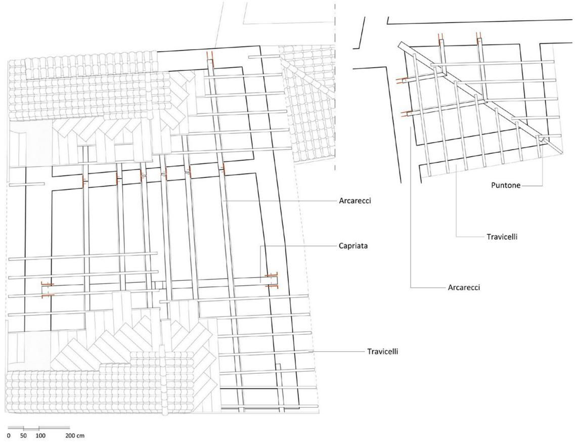
DETTAGLIO DELLA COPERTURA CON STRUTTURA A CAPRIATA
