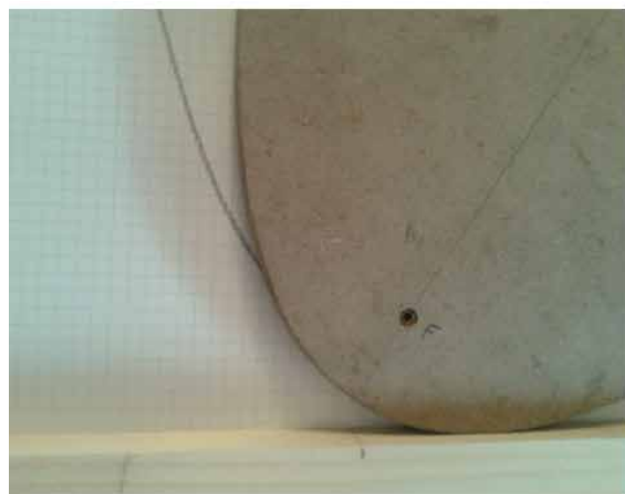
6/ Macchina per il tracciamento della catenaria come roulette della parabola. A destra, il fuoco f della parabola, dove si posiziona il tracciante
