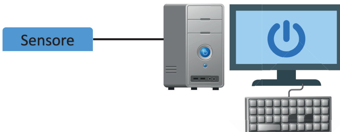
Figura 2.4 - Semplice sistema DAQ – Vista esterna
