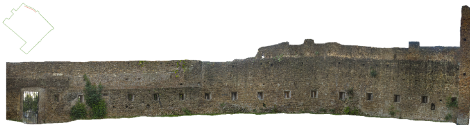
Fig. 4. Cinta del Giardino degli Aranci, lato E: prospetto interno del segmento NE e sua localizzazione in pianta (ortofoto, rilievo fotogrammetrico, piante e grafica di E. Santella).
