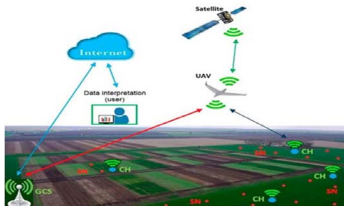
Figura 4 – Il concetto del veicolo aereo senza pilota integrato (UAV) – rete di sensori wireless (WSN) – sistema Internet of Things (IoT)
